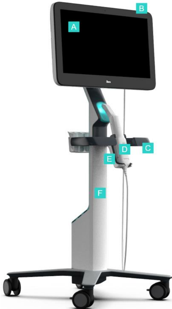
Σχεδιάγραμμα 4: Πρόσθια όψη του iTero Element 2 Plus ενδοστοματικού σαρωτή διαμορφωμένου ως ιατρικό καρότσι
